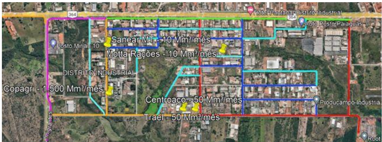
Trajeto da linha de distribuição do Gasoduto do Distrito Industrial de Cuiabá.
